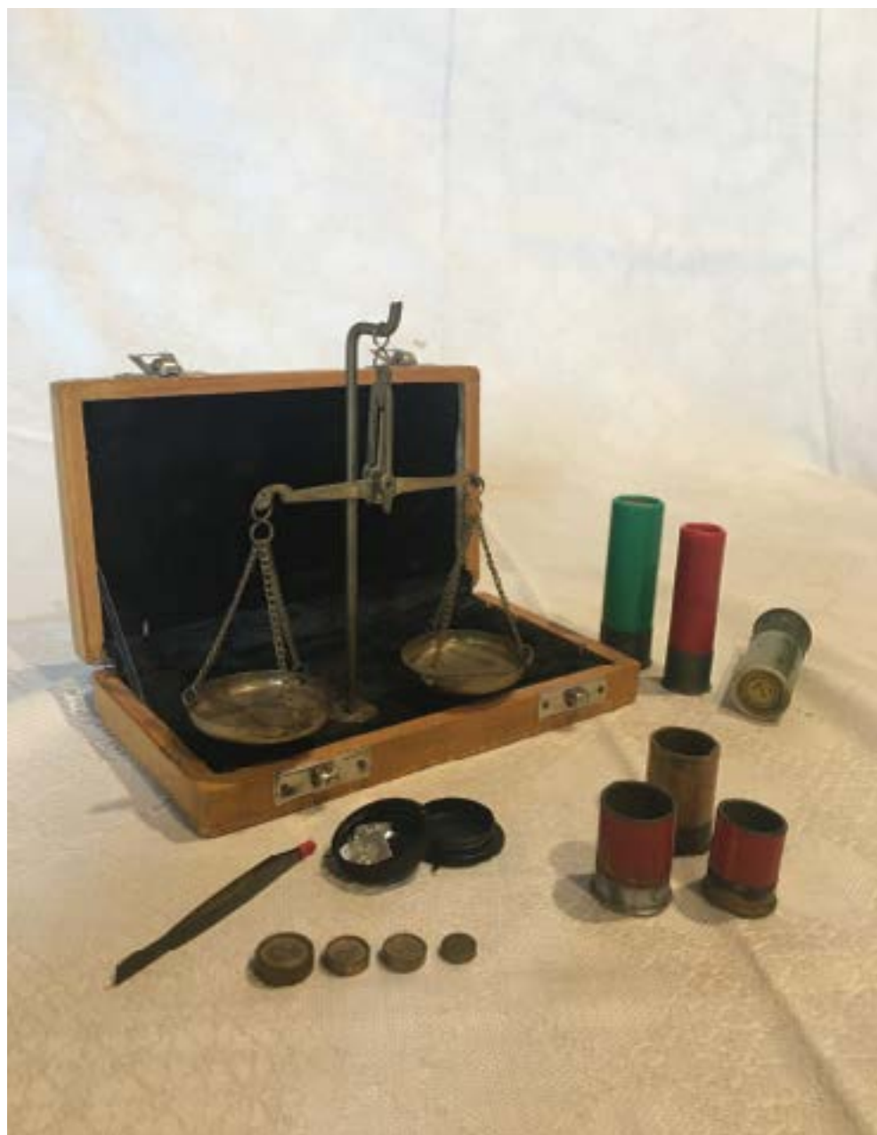
| Piccola bilancia portatile, utile per pesare la polvere da sparo, la borra e i pallini nella fabbricazione delle cartucce
